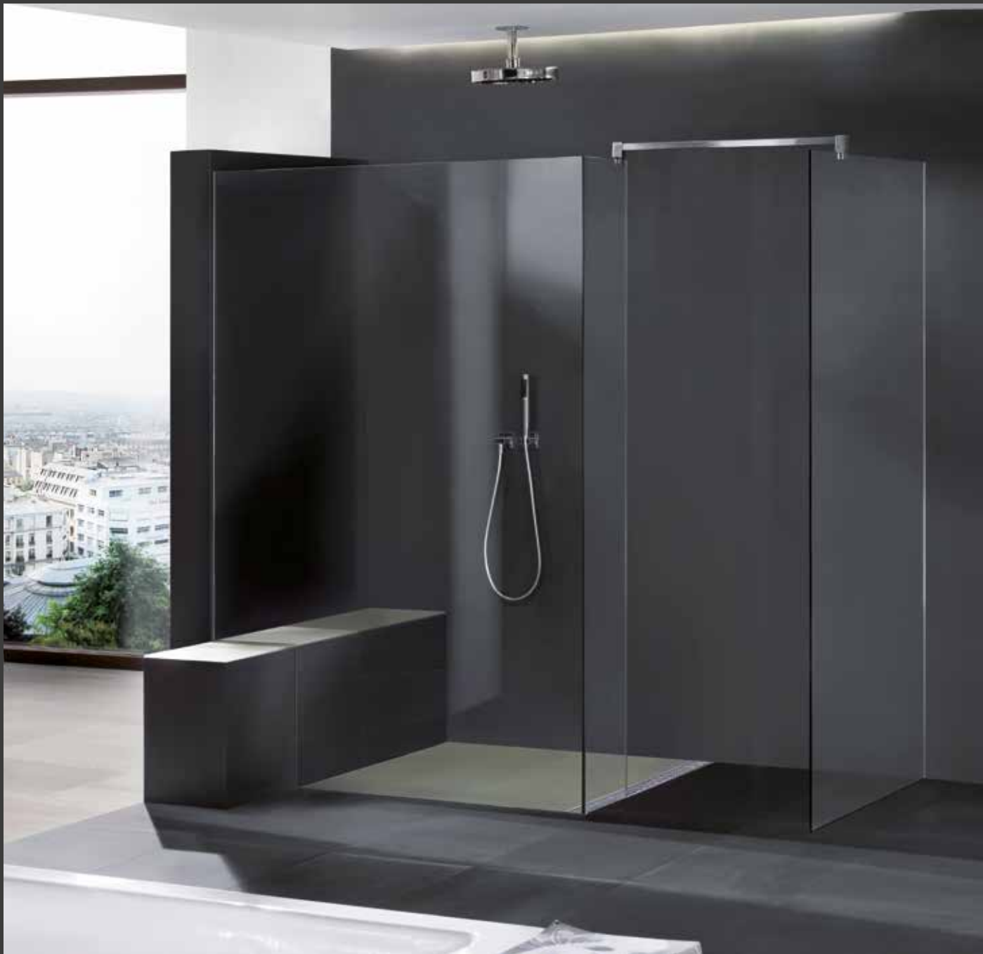
unikat Modell 994, Walk-In-Dusche. U-Profil in Wand integriert. Festteile mit Gehrungskante, nur geklebt.
